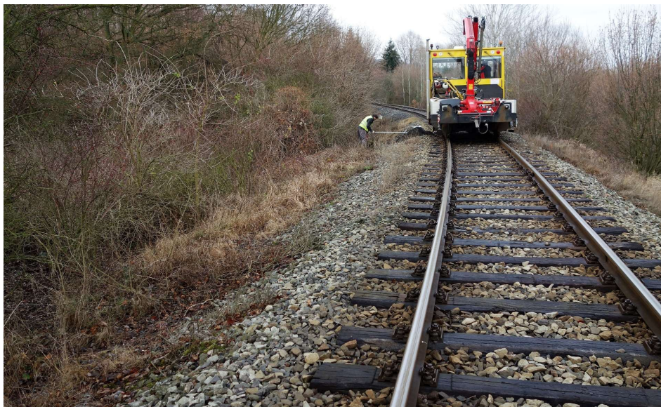
Foto 3: Statická zatěžovací zkouška v sondě K3 v km 33,080/L
