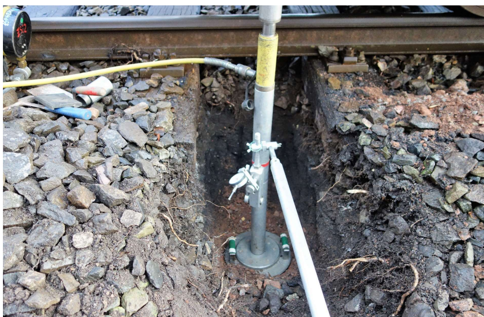
Foto 6: Statická zatěžovací zkouška v sondě K4 v km 33,850/L
