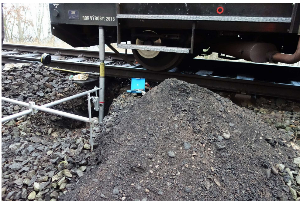
Foto 8: Sonda K5 v km 35,150/L - statická zatěžovací zkouška
